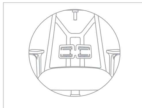
Apoyo lumbar pivotante con 15 posiciones en altura
