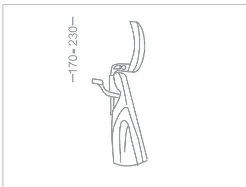
Cabezal pivotante regulable en 11 posiciones.
