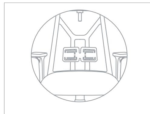
Apoyo lumbar pivotante con 15 posiciones en altura
